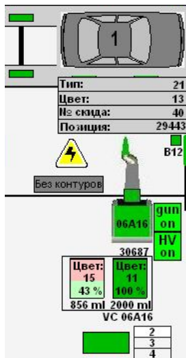
Рис. 9. Часть окна панели мониторинга оператора
