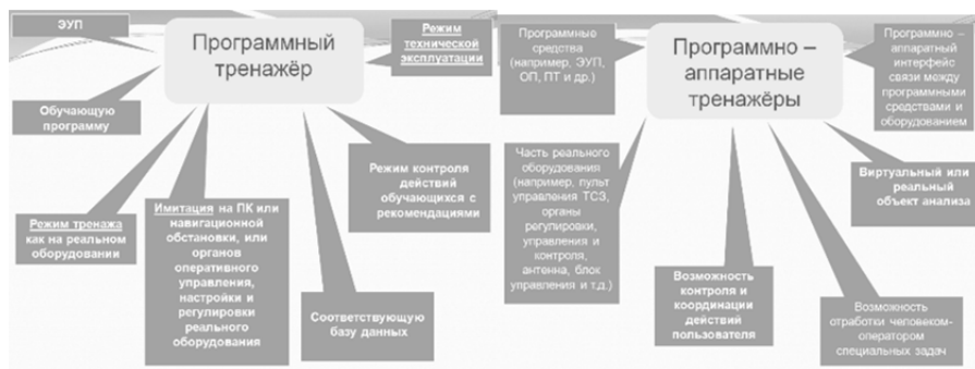
Рис. 2. Содержание и структура программных и программно-аппаратных тренажеров
